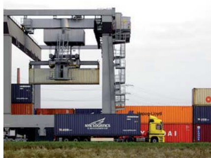
Las cargas suspendidas pueden posicionarse con exactitud por medio de un motor y de realimentación de encoder.
